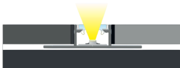
Effetto finale del montaggio per il profilo "Vira" con copertura "Forte".
