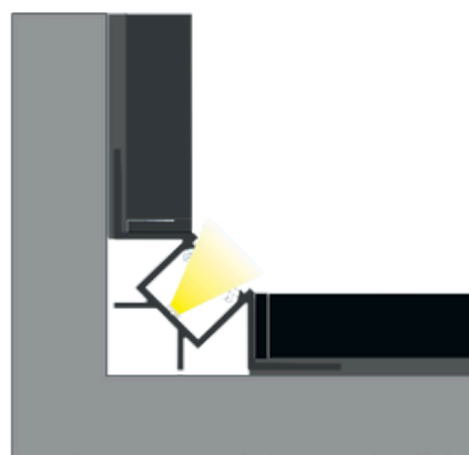
Istruzioni di installazione per il profilo "Siva" con copertura "Semplice".
