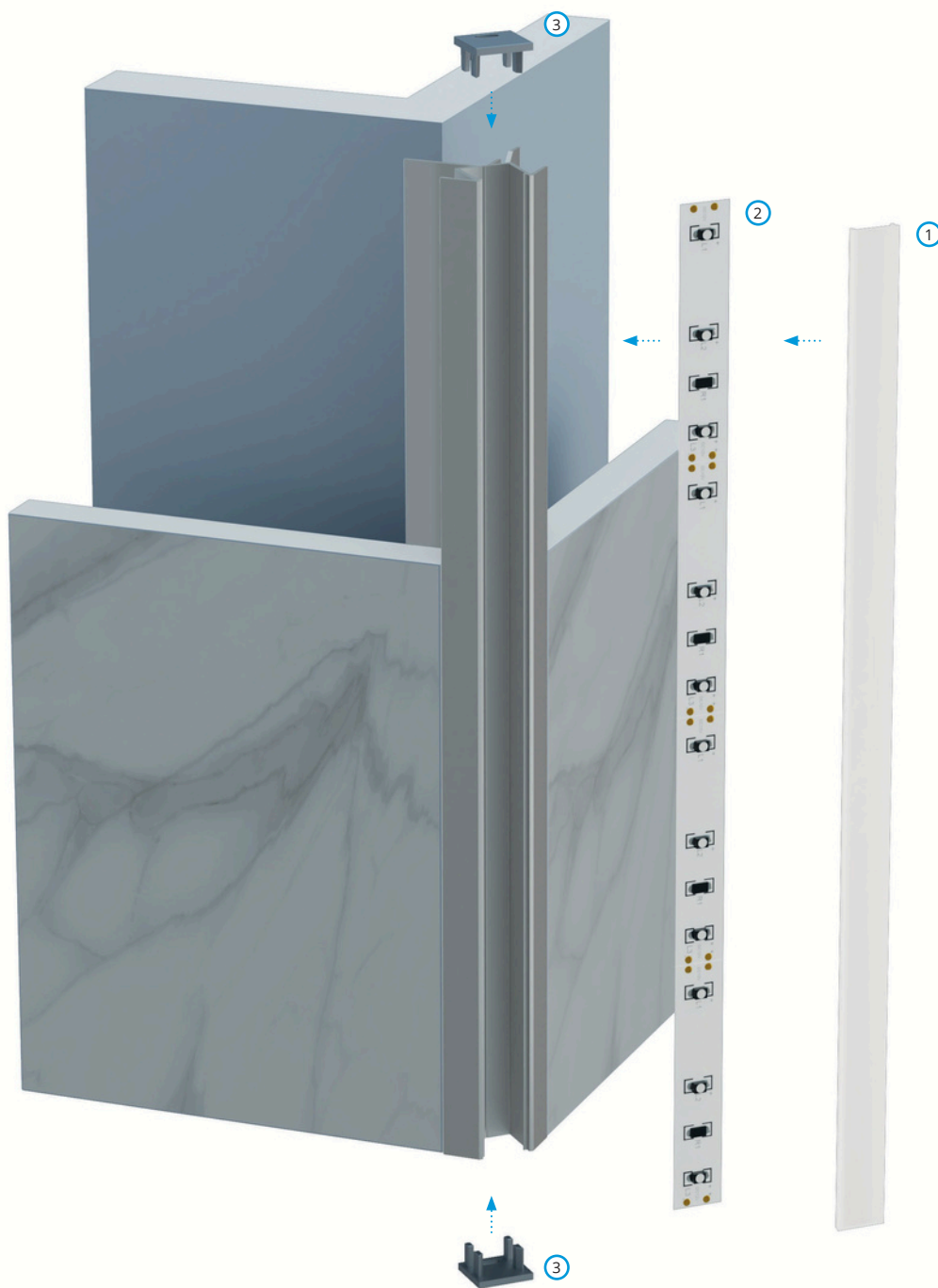
Schema di assemblaggio degli elementi del sistema di illuminazione a soffitto utilizzando il profilo "Kira" e (1) copertura "Semplice" (2), striscia LED e (3) tappo terminale con foro.
